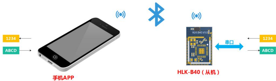
图 1 一对一蓝牙连接透传功能示意图
